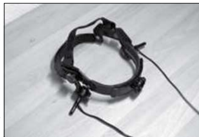
Головной шлем с двумя доплеровскими зондами на 2МГц импульсного излучения (PWD) для проведения длительного мониторинга и детекции эмболии
